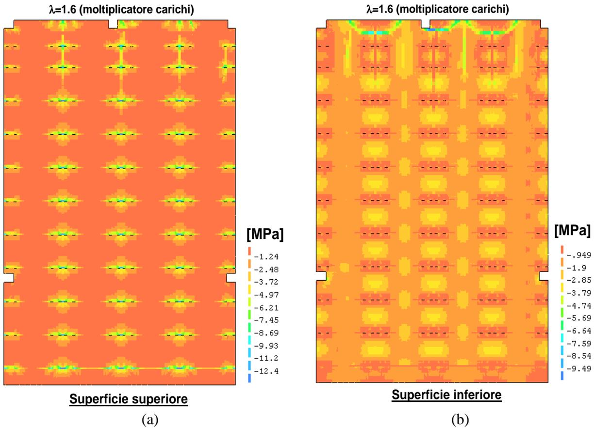
**Figura B.13.** Mappa degli sforzi principali minimi sulla superficie superiore (a) e inferiore (b) della pavimentazione in corrispondenza di un moltiplicatore dei carichi  $\lambda=1.6$ .
